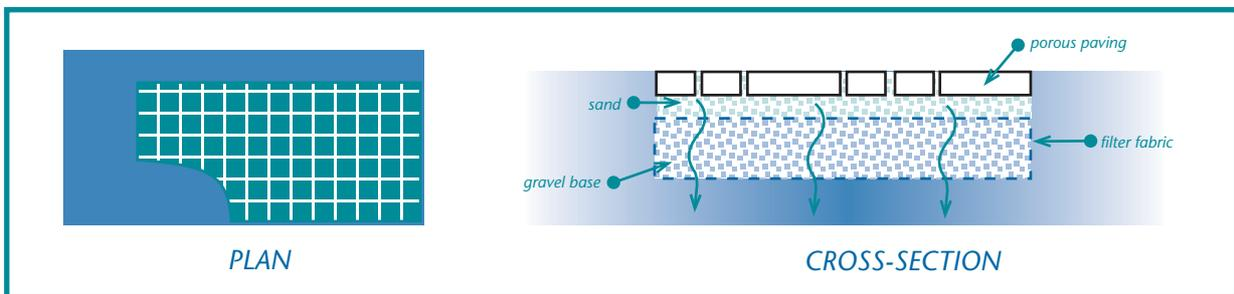
Figure 4 - POROUS PAVING
