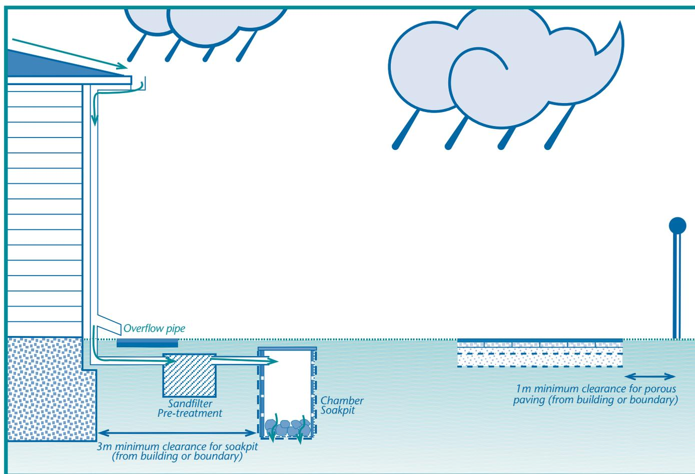
Figure 2 - TYPICAL RESIDENTIAL SOAKAGE SYSTEM
